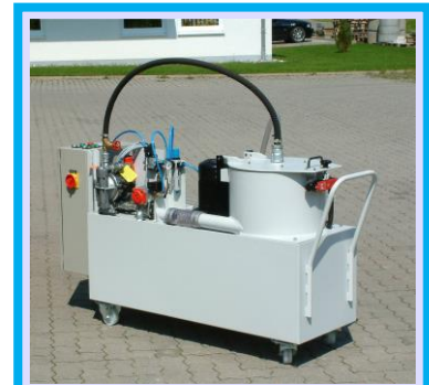
Reinigungszentrifuge RZS 60 zur direkten Pflege des Schmierstoffes in der Fertigungsmaschine
